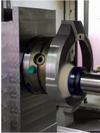
In 2 minuten maakt de komborstel op het bewerkingscentrum de messcherpe randen van de gietaluminium behuizingen mooi smooth, zonder iets aan de maatvoering te veranderen.
